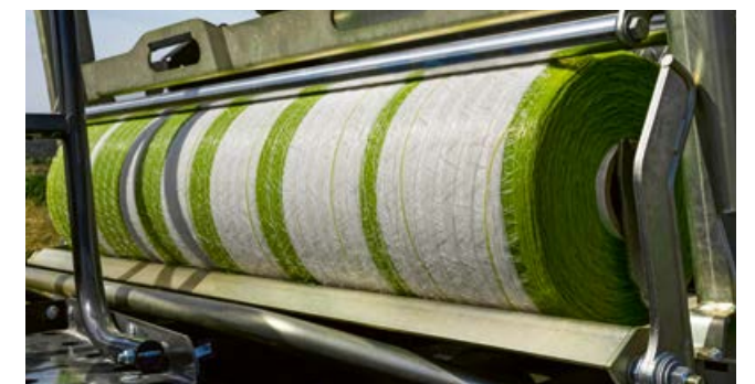
Нова система обв'язування серії VARIANT 500 розташована на 25 см нижче, що дозволяє легко очищувати рулон сітки під гальмом.
