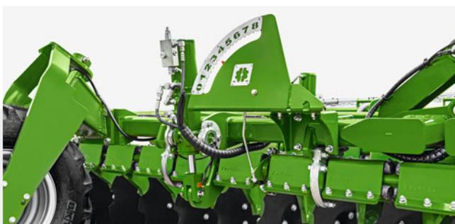
Гидравлическая регулировка глубины обработки с хорошо обозримой шкалой
