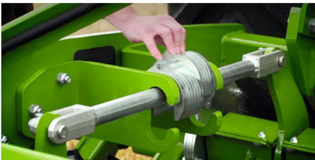
✓ Механическая регулировка глубины обработки с помощью регулировочных клипс – здесь установка на поверхностную обработку
