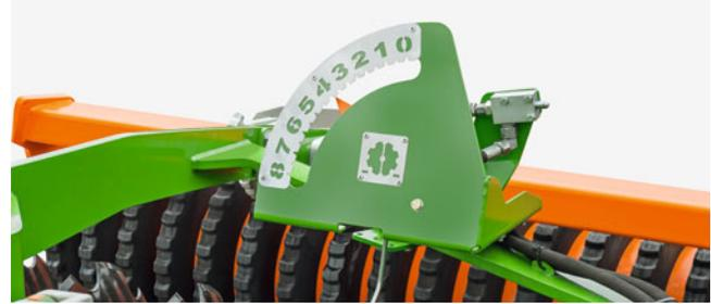
Гидравлическая регулировка глубины обработки с хорошо обозримой шкалой
