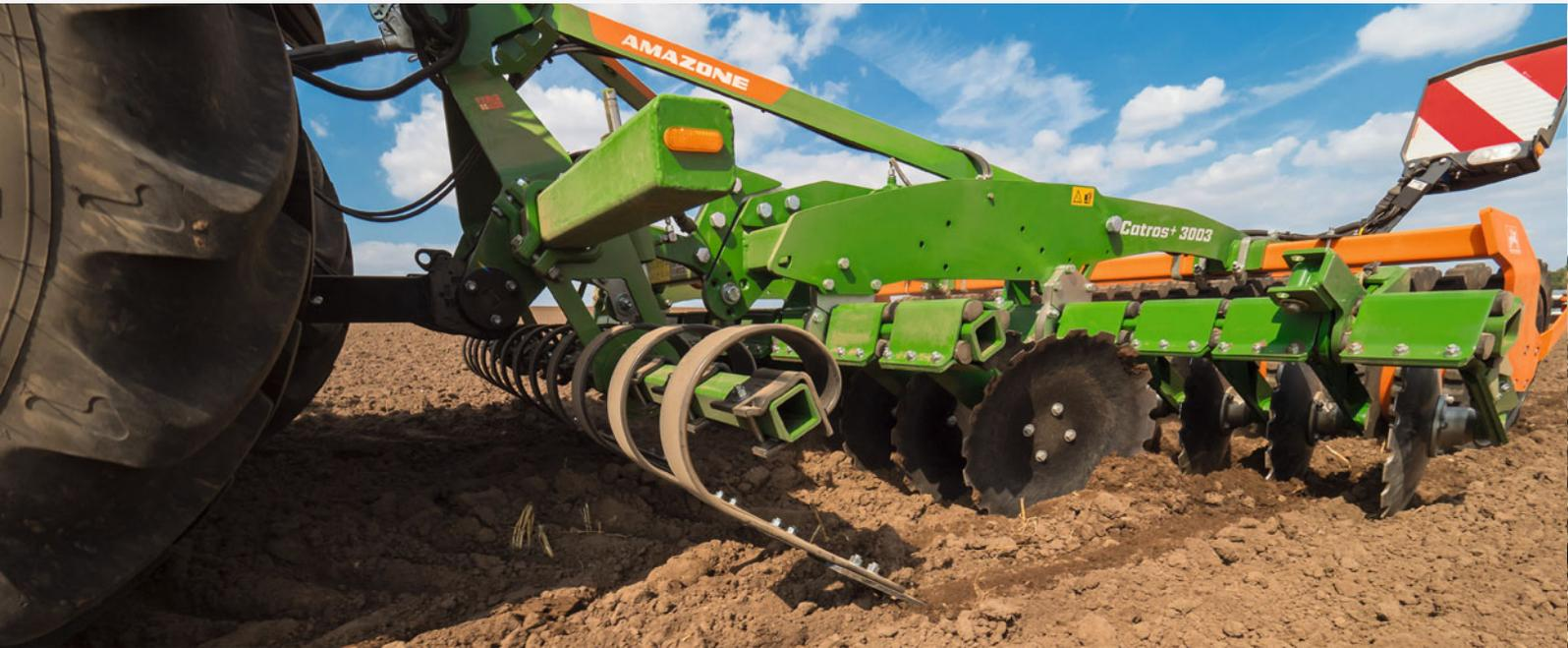
Для лучшего выравнивания и крошения опционально предлагаются выравниватели Crushboard. С помощью такого специального оснащения крупные комки земли на поверхности, например, после вспашки, могут быть раздроблены, а семенное ложе оптимально подготовлено. Дополнительно имеется также возможность размещения выравнивателя Crushboard за батареей дисков.
