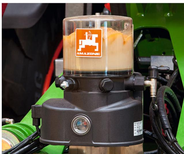
Насос с резервуаром для смазки
