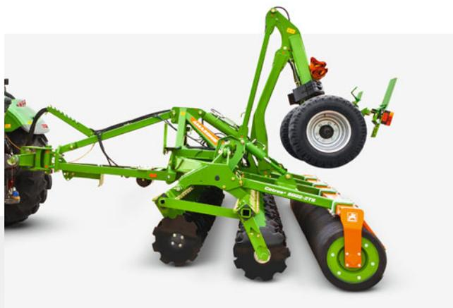
Catros<sup>+</sup> 6002-2TS – без переуплотнения почвы на разворотной полосе благодаря развороту на катке
