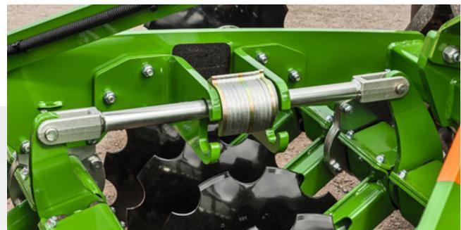
✓ Механическая регулировка глубины обработки с помощью регулировочных клипс – здесь установка на среднюю глубину обработки
