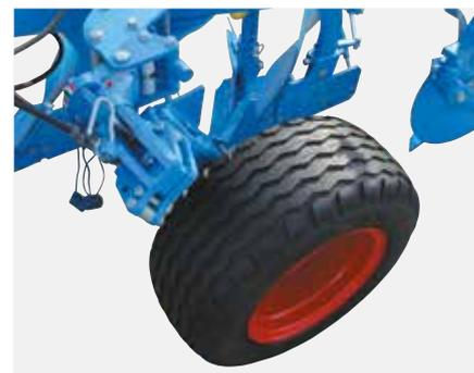
**Гидравлическое опорно-транспортное колесо УНИРАД**
