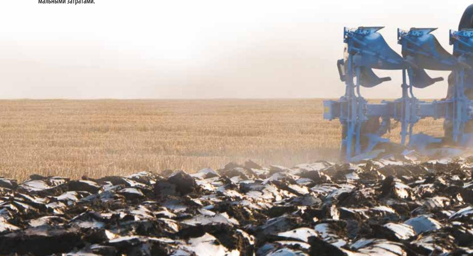
Сменное остриё лемеха гарантирует благодаря его толщине, материалу и форме минимальный износ и всегда оптимальное вхождение в почву. Особенно широкие полевые доски с большими опорными площадками обеспечивают лучшее ведение плуга в борозде. Они могут четыре раза переворачиваться. Значительно увеличенная часть изнашиваемого материала позволяет длительное использование ножа полевой доски. Его крепление находится вне зоны трения, благодаря чему обеспечивается ее защита от износа и повреждений.
