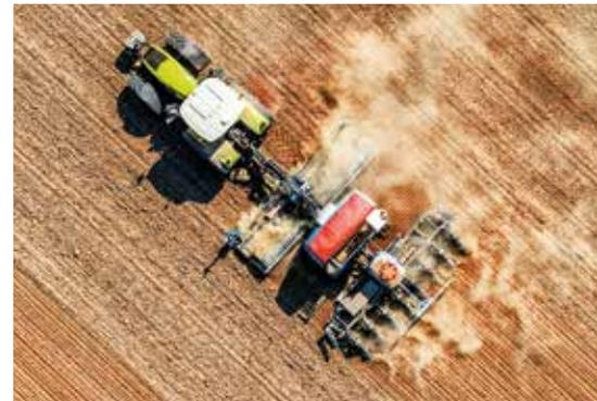
Производитель инновационной посевной техники компания LEMKEN теперь внедряет новые технологии и в области точного высева. Отправной точкой для инноваций в области точного высева является технология DeltaRow, которая обеспечивает улучшенное распределение растений по площади поля. Чем больше питательных веществ, воды
