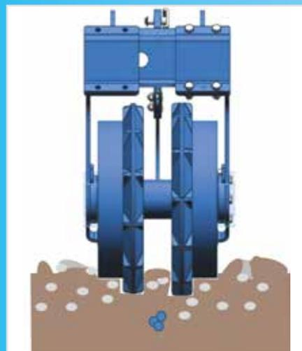
Трапециевидный уплотняющий каток закатывает ленту с удобрениями и одновременно обеспечивает обратное прикатывание горизонта посева. Это способствует капиллярному подъему влаги и, соответственно, быстрому и равномерному всходу растений.
