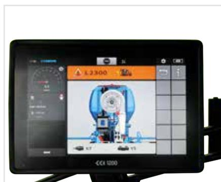
MegaSeed — это новая концепция управления на базе ISOBUS, выполненная в едином дизайне LEMKEN и предназначенная для сеялки точного высева Azurit 9.
