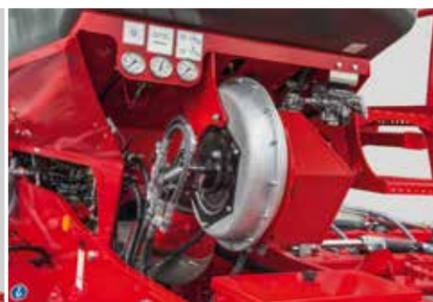
Гидравлический привод вентилятора
