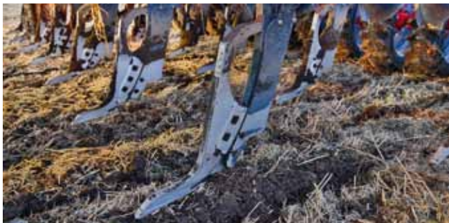
Ультра узкие наконечники Ultra LD позволяют проводить глубокую обработку почвы без образования глыбистой поверхности
