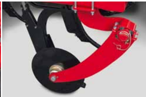
Диск-отбойник предотвращает образование борозд между проходами машины
