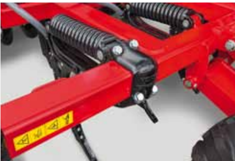
TerraGrip III Сила срабатывания 800 кг
