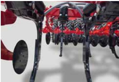
Каждая стойка TerraGrip расположена строго напротив колеса почвоуплотнителя
