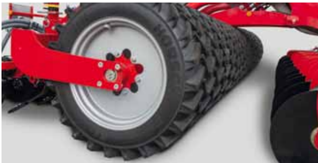
Колёсный почвоуплотнитель для поддержания глубины обработки и уплотнения посевного ложа перед посевом.
