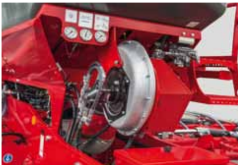
Гидравлический привод вентилятора Прямой привод от гидравлики трактора с удобным расположением шлангов
