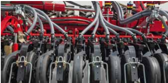
Сошник TurboDisc осуществляет посев точно в центр борозды, проделанной стойкой TerraGrip и уплотнённой колесом почвоуплотнителя
