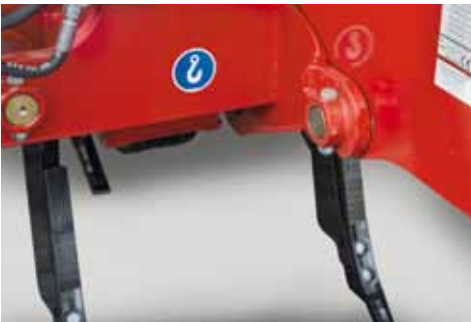
Удобное переоборудование рабочих органов. Замена рам со стойками на дисковые батареи происходит посредством 4 резьбовых соединений.
