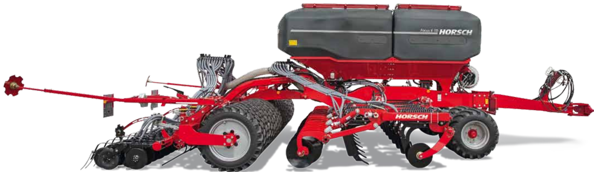
Четыре зоны Focus TD Высевающие сошники TurboDisc – колесный почвоуплотнитель – выравнивающие диски – стойки TerraGrip с узкими LD-лапами для внесения удобрений
