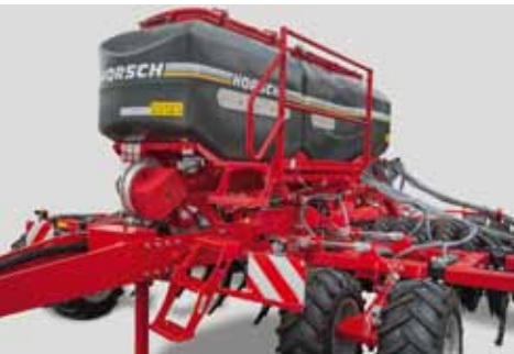
Удобная лестница с рабочей платформой для заправки и контроля бункера
