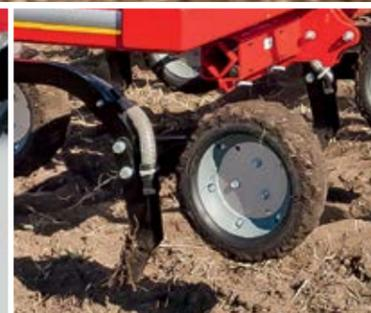
Сошник Дуэт без (слева) и с внесением гранулированных удобрений (справа) с блоком MultiGrip – комбинированный рабочий орган для одновременного посева и внесения удобрений
