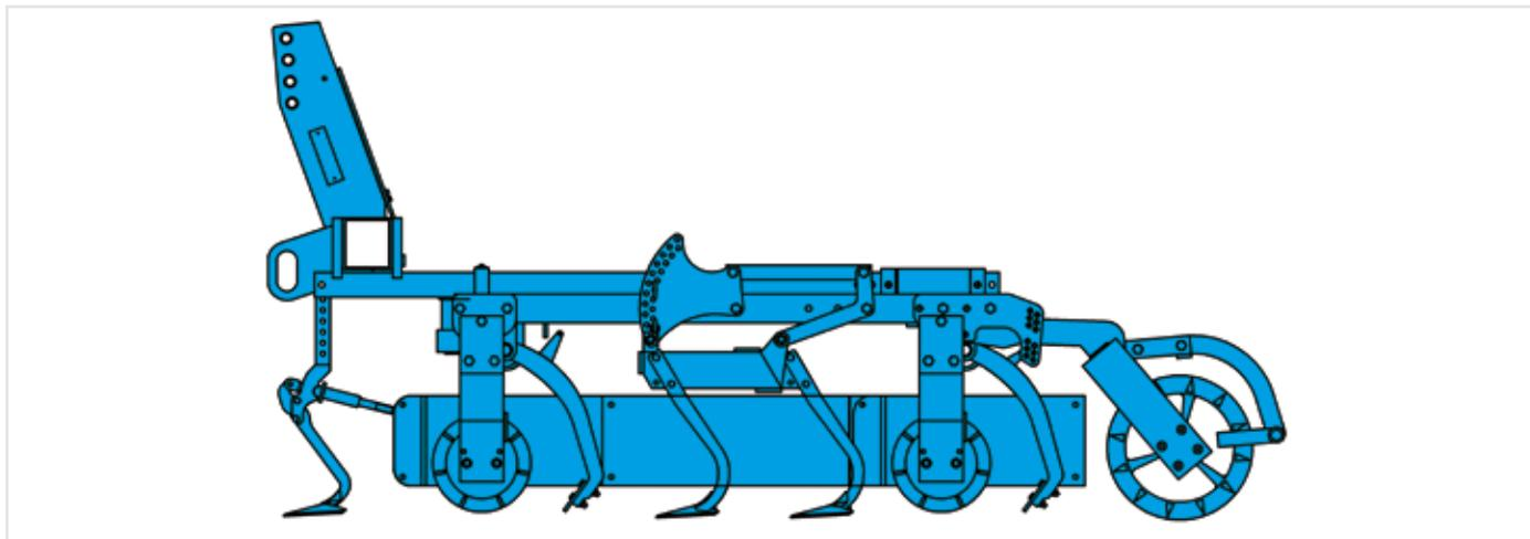
С помощью System-Kompaktor часто достигается желаемое качество обработки почвы уже после первого рабочего прохода. Его производительность значительно выше, чем у орудий, работающих от вала отбора мощности.
