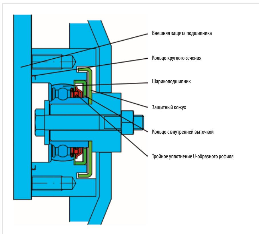
Новое поколение не требующих технического обслуживания подшипниковых узлов полностью герметизировано и таким образом надежно защищено от загрязнений, что гарантирует длительный срок службы. Круглая форма корпуса подшипника предотвращает попадание посторонних предметов и забивание камнями. Если необходимо заменить подшипниковый узел, то дополнительный разъем на раме значительно упрощает замену.
