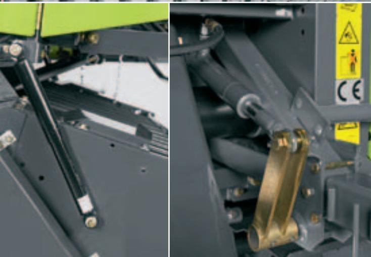
При опускании гидравлической системы всегда соблюдается предварительно установленное расстояние подборщика. Захватный ротор за подборщиком активно подает растительную массу в камеру прессования.
