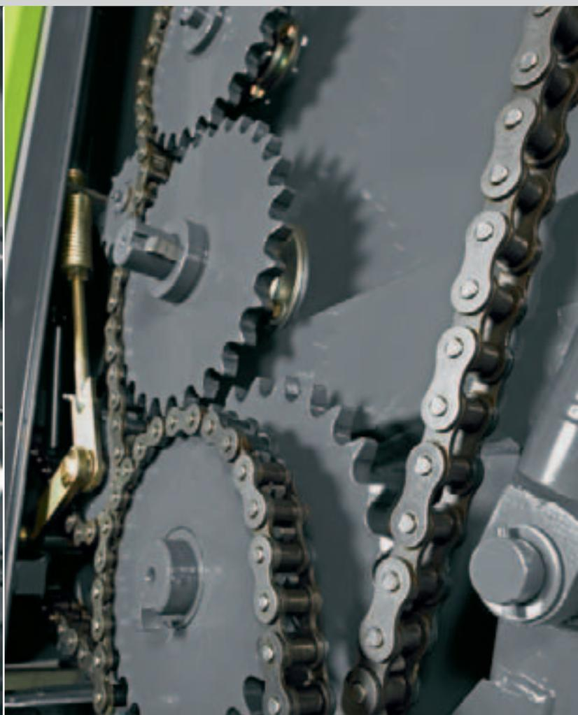
Прочные цепи, автоматическое натяжение и смазка – необходимое условие высочайшей надежности.
