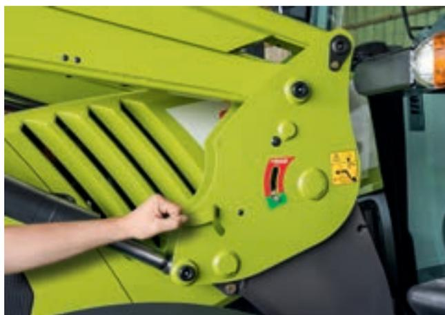
Благодаря специальному индикатору механизатор может проверить надежность закрепления устройства на фронтальном погрузчике из кабины. Расцепление выполняется так же быстро и просто.
