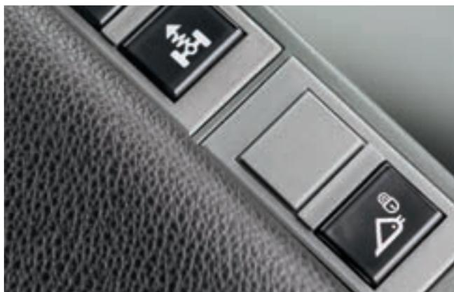
Благодаря функции FASTLOCK достаточно простого нажатия кнопки, чтобы сцепить и расцепить рабочее устройство.
